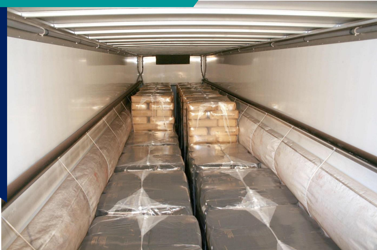
Ladungssicherungssystem im Kofferaufbau mit Rolling-Floor Boden aus 2005
